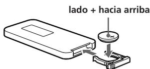
Sustituya la pila por una de litio DL-2025 de Duracell o CR2025 de Sony. El uso de otro tipo de pila puede presentar el riesgo de incendios o explosión.
