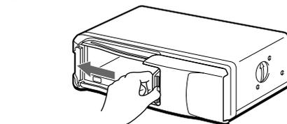
Emplee el cargador de discos suministrado o el XA-250. El cargador de discos XA-10B no puede utilizarse con esta unidad. Si emplea otro tipo de cargador, puede producir fallos de funcionamiento.
