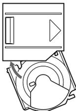
Com a parte recortada do tabuleiro virada para si, introduza o canto direito do tabuleiro na ranhura e depois empurre o canto esquerdo para dentro até ouvir um estalido.
