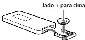
Substitua a pilha por uma pilha de lítio Sony CR2025 ou Duracell DL-2025. A utilização de outro tipo de pilha pode provocar incêndios ou explosões.
