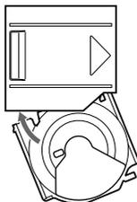
Con la parte de corte de la bandeja hacia fuera, inserte la esquina derecha de dicha bandeja en la ranura y, a continuación, presione la esquina izquierda para introducirla hasta oír un chasquido.
