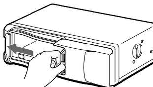
Utilize o carregador de discos fornecido ou o carregador XA-250. Não pode utilizar o carregador de discos XA-10B com este aparelho. Se utilizar outro carregador qualquer pode provocar uma avaria.
